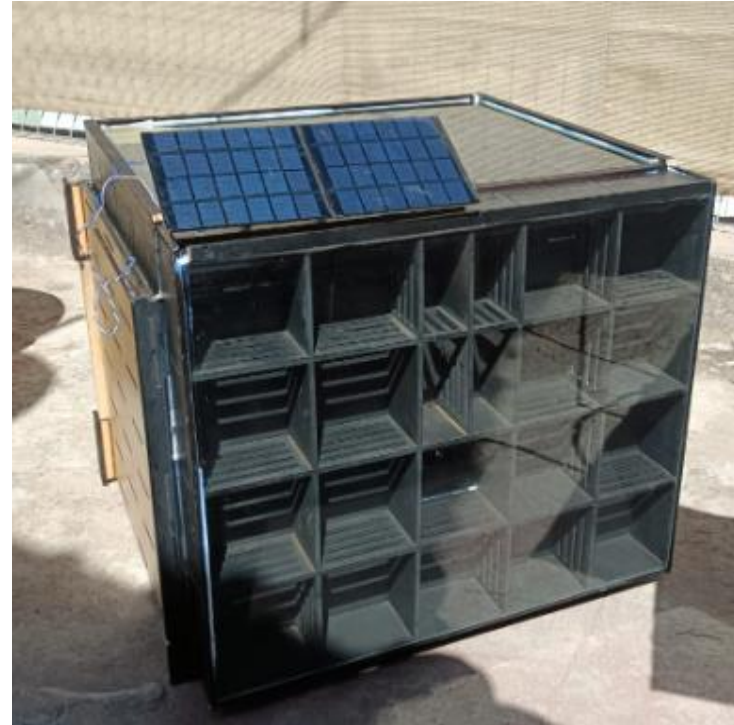
Figura 15 Acabado Final del Secador Solar
